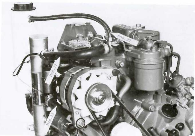
4. Färskvattensidan: Montera 90° formgjuten slang (pos. 21) mellan utloppsröret (pos. 34) på termostathuset till den raka övera anslutningen på värmeväxlaren. Färskvatten ut. Montera formgjuten slang (pos. 22) mellan cirkulationspumpen och inloppsröret in i motorn (ev. kan det vara lättare att lossa röret, montera slangen och återmontera röret). Montera avluftringsslang mellan utloppsrörets anslutning och expansionstanken.
