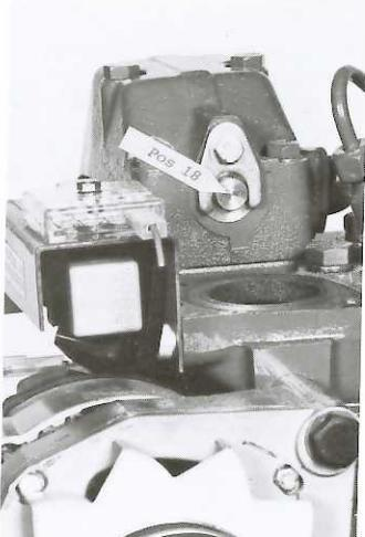
1. Demontera termostathuset och röret in i avgaskröken. Plugga utloppet i topplocket med blindplugg (pos. 18) och packning från röret. Vänd termostathuset 180° så att utloppet pekar framåt. Montera den medleverade termostaten (pos. 19) samt 90° utloppsrör (pos. 34). Demontera slangen mellan sjövattenspumpen och inloppsröret in i motorn.
