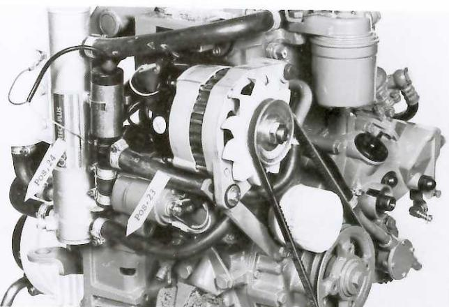
5. Sjövattensidan. Montera formgjuten slang (pos. 23) mellan röret vid sjövattenspumpen till värmeväxlarens nedre raka slanganslutning riktad framåt. Sjövatten in. Montera formgjuten 90° slang (pos. 24) mellan värmeväxlarens aktra raka slanganslutning till det avkapade röret vid avgaskröken. Sjövatten ut. Se bild.
