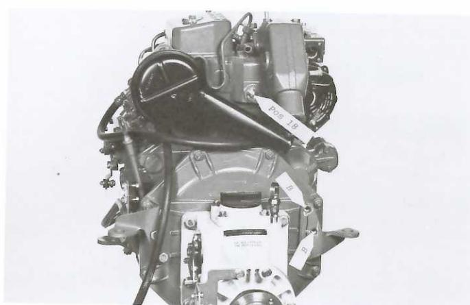
2. Demontera röret mellan topplocket i bakkant och avgaskröken. Kapa röret med en bågfilt så att ca 20–25 mm av den raka delen efter 90° kröken återmontera det kapade röret vid avgaskröken. Plugga inloppet i avgaskröken med blindplugg (pos. 18) och packning från röret. Demontera de två övre M 10 bultarna på s.b. motorfäste med 17 mm nyckel.
